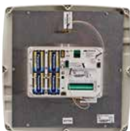
Centrala XTO z kartą SIM lub kartą WiFi zewnętrzna, obsługuje do 24 kamer OMV
